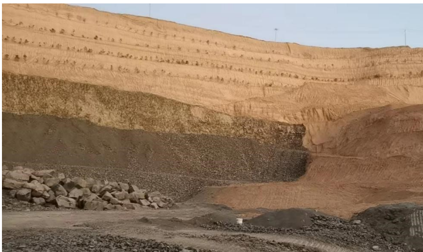
照片 2-8 露天采场东部边坡台阶种树
